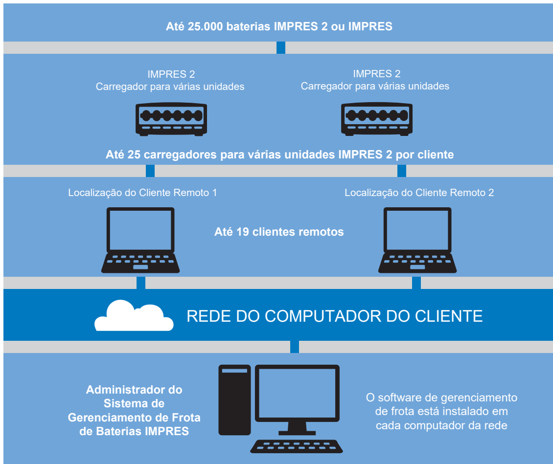
Figura 23: Gerenciamento da bateria IMPRES por carregadores de rede
