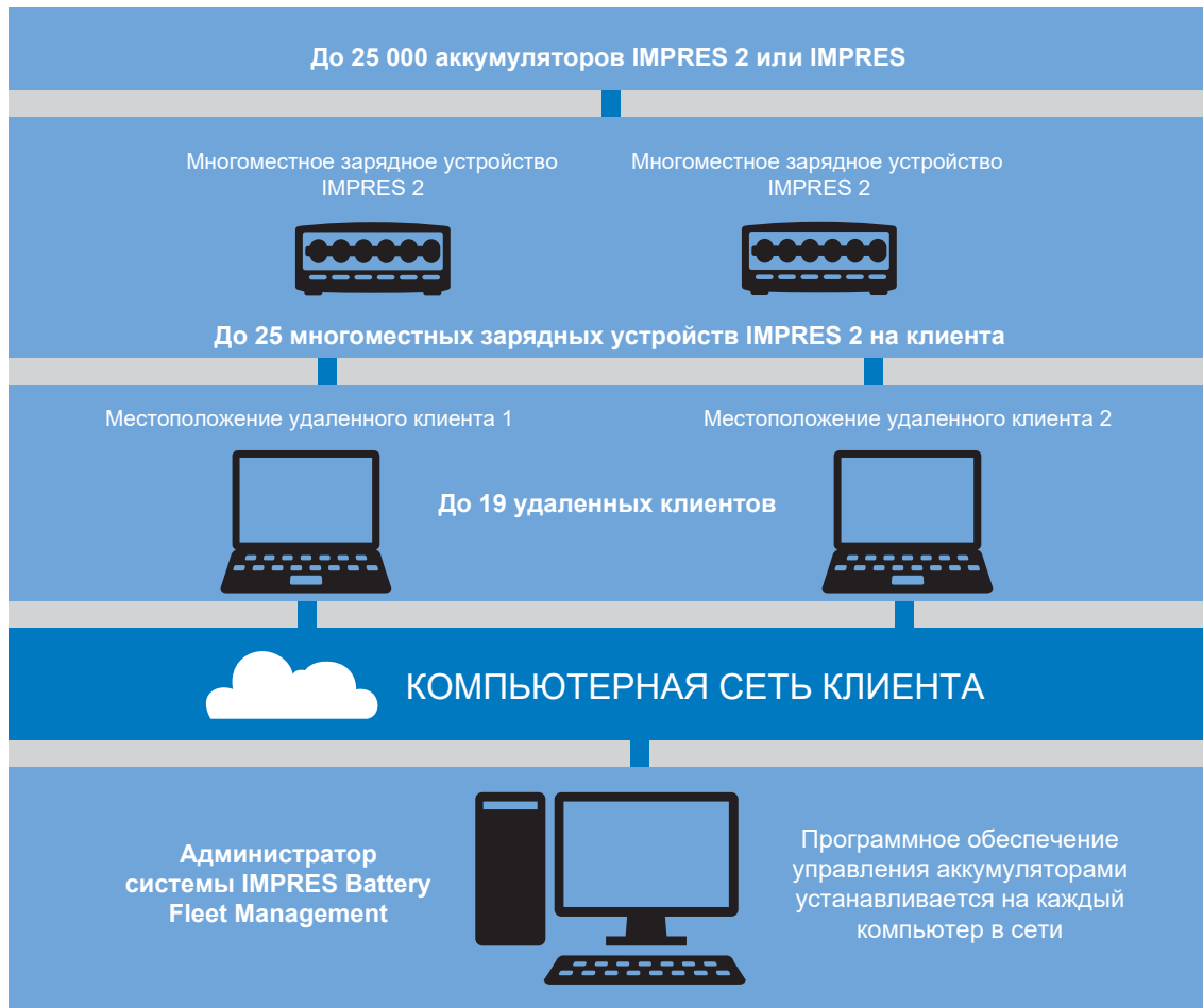
Рис. 23. Управление аккумуляторами IMPRES через сетевые зарядные устройства
