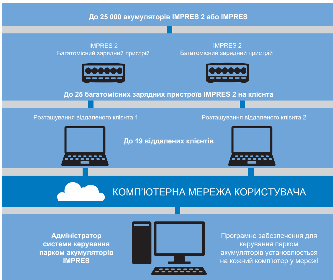
Рисунок 23. Керування акумуляторами IMPRES за допомогою мережевих зарядних пристроїв
